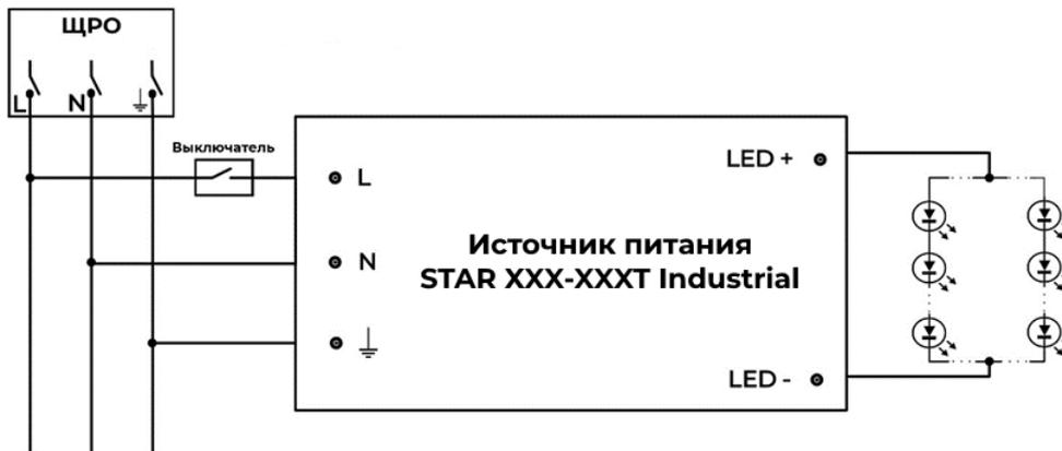
Рисунок 3 – Схема подключения источника
